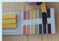
Slika 10. Određivanje pH - vrijednosti nezrelog sapuna
